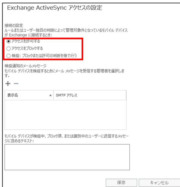
「接続の設定」で「検疫」を選択した場合、モバイルデバイスがアクセスすると「検疫されたデバイス」の一覧に、アクセスしてきたデバイスの一覧が表示されます。必要に応じてアクセスを許可または拒否できます。
